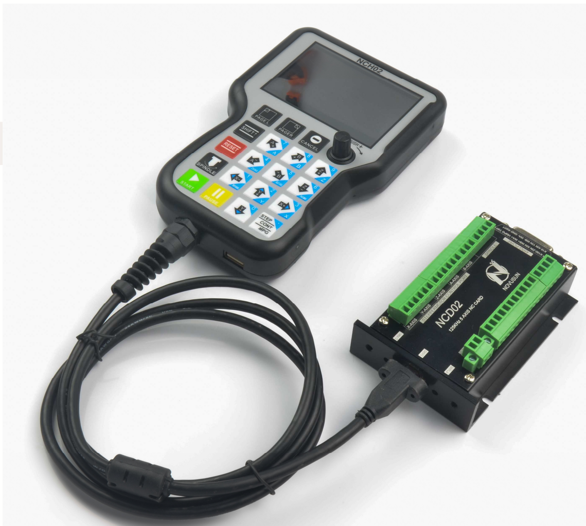
图1-3. NCH02 手持与 NCD02 主机连接
