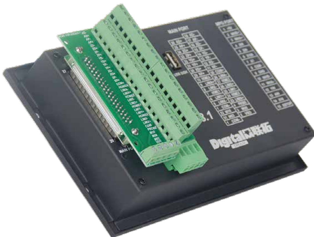
图 2-8 主接线接口的接线端子
