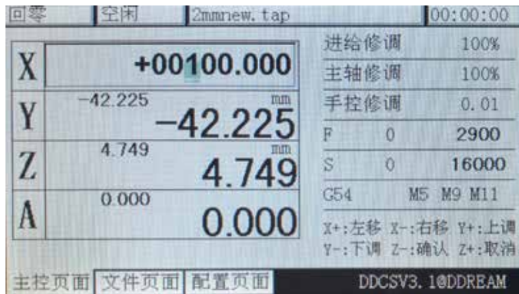
图 3-43 进入X轴“回零”模式将当前X坐标值设置为100
